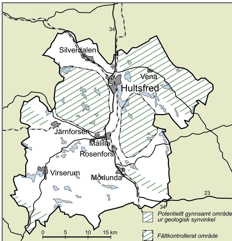
Figur 4-8. Potentiellt lämpliga områden för ett slutförvar i Hultsfreds kommun. Fältkontroller har genomförts i två områden: öster om Målilla och väster om Hultsfred /49, figur 1/.
