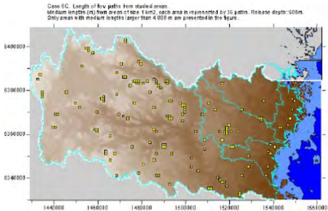
Figur 6-55. Fall 6C. Modell med basnivån vid -3\ 300\text{ m} över havet. Gula rutor markerar försvarsområden (storlek 1\text{ km}^2 ) med medianlängd på flödesvägarna som är större än 4\ 000\text{ m} .
