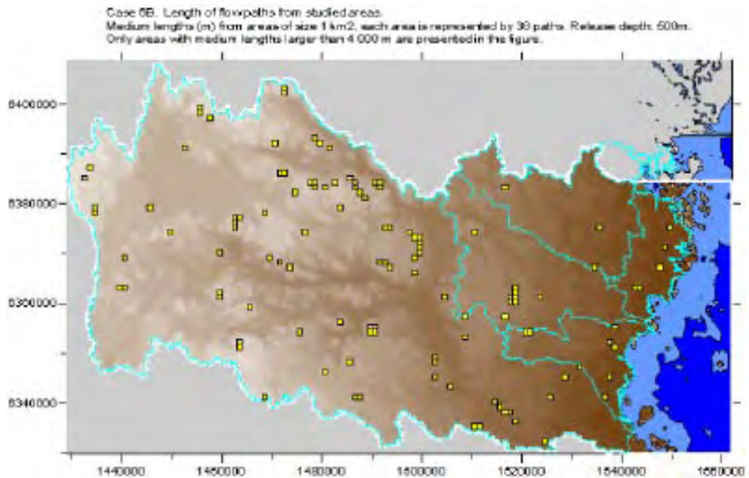
Figur 6-53. Fall 6B. Modell med basnivån vid -1 800 m över havet. Gula rutor markerar försvarsområden (storlek 1 km 2 ) med medianlängd på flödesvägarna som är större än 4 000 m.
