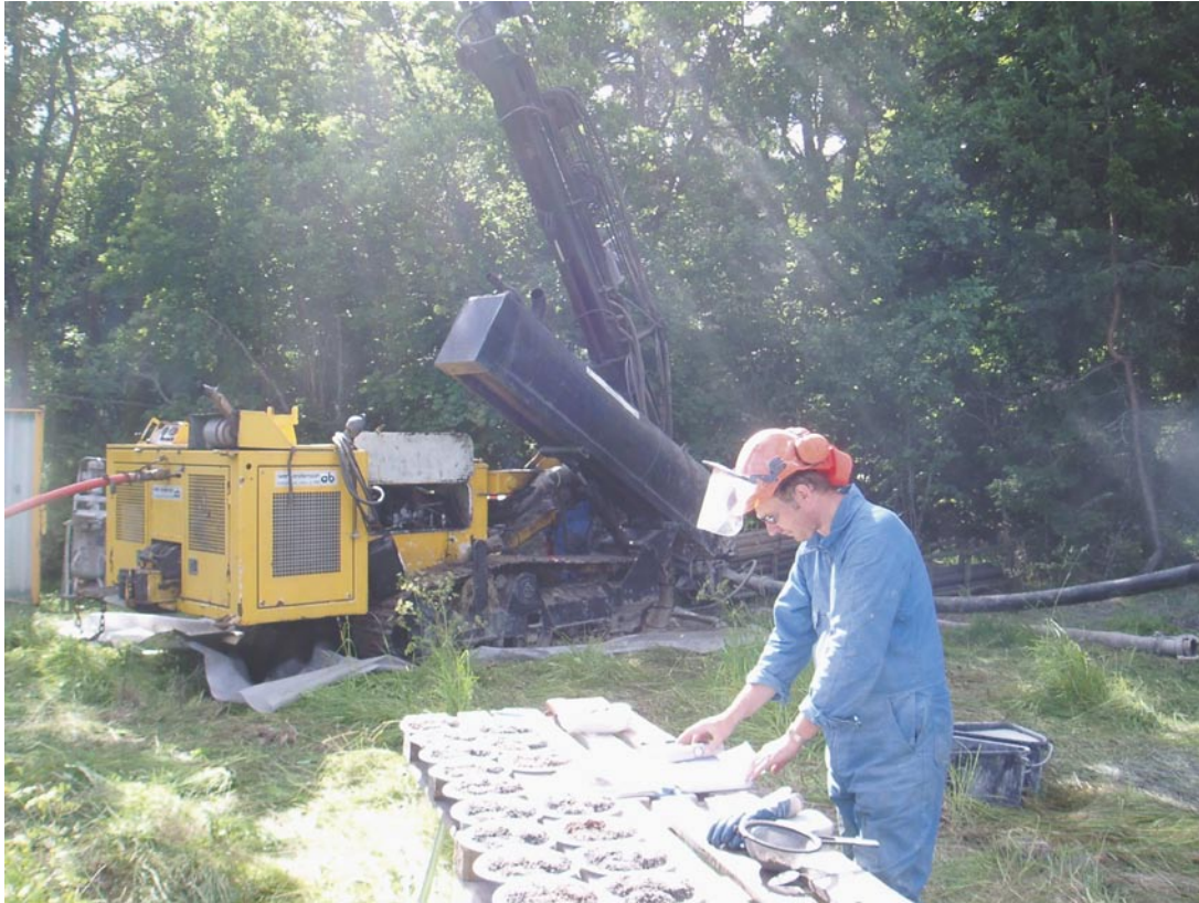
Figur 3-40. Hammarborrning och översiktlig geologisk kartering av borrhax i HLX17.
