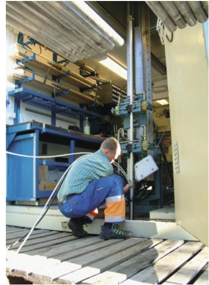
Figur 3-27. Schematisk illustration av PSS-utrustningen. Denna mätmetod utgör tillsammans med PFL en grundpelare i den hydrogeologiska karakteriseringen i kärnbråhåll.
