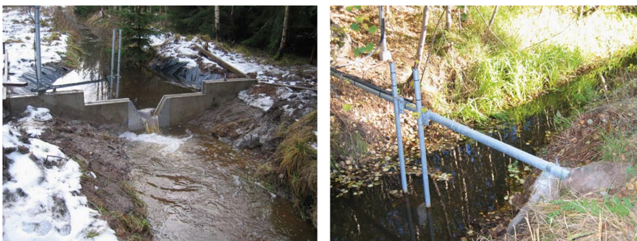
Figur 3-45. Vattenföringsstationer. Den vänstra bilden visar överfallsdamm vid mätstation PSM000347. Den högra är mätstation PSM000353 vid naturligt bestämmande sektion. Stationernas läge visas i figur 3-46 nedan. Sensorer för mätning av nivå, temperatur och elektrisk konduktivitet är monterade på stolpar i mitten av vattendraget.
